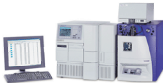
より多くの種類の農薬・動物用医薬品検査に対応するため導入した高速液体クロマトグラフ・タンデム質量分析計
