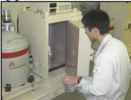
ゲルマニウム半導体検出器を用いて、食品中の放射性物質を測定します。
