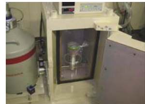
ゲルマニウム半導体検出器で検査
